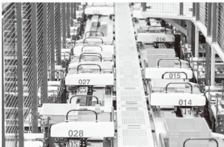
最大40台の台車を一括制御し最適割り付けを行う
